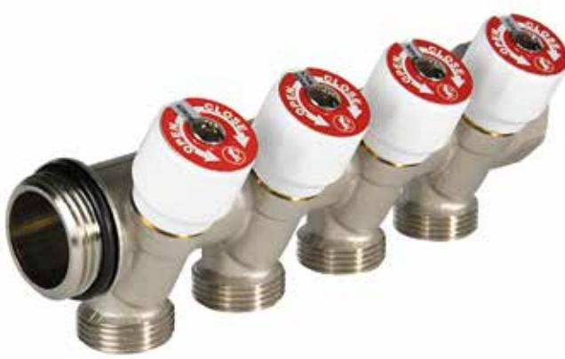
Сборные коллекторы из латуни никелированные для водоснабжения (Сантехнические коллекторы), с запорными кранами, подсоединение трубы адаптером 3/4" евроконус. Для соединения коллекторов предусмотрена синхронизированная резьба с уплотнением для точного позиционирования относительно оси отводов. В комплект коллекторов входят маховики с бирками для обозначения различных точек водоразбора. Опционально можно заказать торцевые заглушки, шаровые краны и шкаф для комплектации коллекторов.
