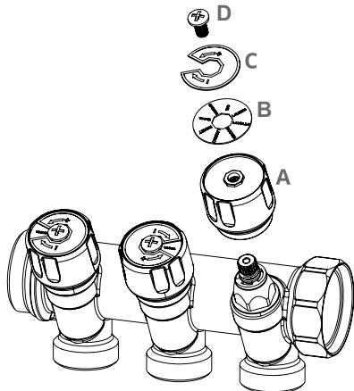
Маховики (A) соединены с запорным краном винтом (D) и включают в себя две металлические пластины: - пластина (B) показывает соответствующую точку использования (например, душ, раковина и т. д.); - Пластина (C) располагается над пластиной (B) и имеет синюю и красную стороны, что позволяет быстро определить коллектор горячей или холодной воды. Это позволяет оптимизировать количество хранимой продукции.
