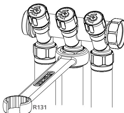
Расстояние между центрами отводов 40 мм позволяет также использовать переходники для пластиковых или многослойных труб диаметром 20 мм (R179EX027).
