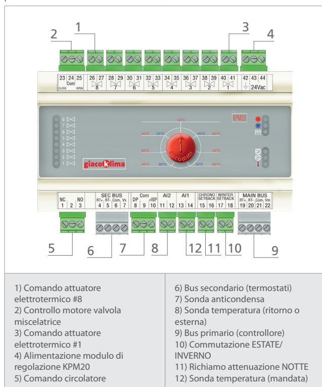
Un morsetto (3 poli: DEC, com, INC) è dedicato al collegamento del motore K280 per il controllo di una valvola miscelatrice R298.
