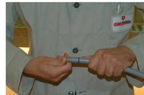
4) Esercitando sufficiente pressione si spinge a fondo il tubo nel raccordo fino in battuta (e fino al segno fatto in precedenza). Nell'inserimento del tubo si verificano due sussulti dovuti rispettivamente al passaggio attraverso l'anello O-ring ed in seguito al passaggio attraverso l'anello dentato di bloccaggio. La profondità di innesto del tubo nella tasca del raccordo è di 25 mm. Ad inserimento effettuato si può verificare che tirando il tubo questo risulti irreversibilmente bloccato.
