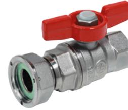
Valvola a sfera, con attacchi filettati femmina-femmina con calotta prigioniera e guarnizione di tenuta, con bocchettone telescopico (regolazione lunghezza valvola: 8 mm), specifica per collegamento contatori.
