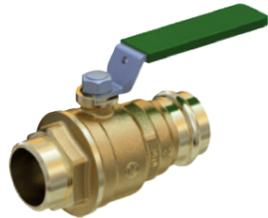
Valvola a sfera, con attacchi filettati maschio-a pressare (per tubo in rame conforme alla EN 1057; per tubo in acciaio inossidabile conforme alla EN 10217-7 e EN 10312; per tubo in acciaio al carbonio conforme alla EN 10305-3), specifica per acqua sanitaria.
