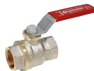
Valvola con sfera DADO, con attacchi filettati femmina-femmina. Passaggio totale. Temperatura minima di esercizio: -20 °C con soluzioni glicolate al 50 % Temperatura massima di esercizio con vapore saturo secco: 185 °C con 1,05 MPa (10,5 bar) Pressione massima di esercizio a 20 °C con acqua e gas non pericolosi: 4,2 MPa (42 bar) per 3/8", 1/2", 3/4" 3,5 MPa (35 bar) per 1", 1-1/4", 1-1/2", 2" 2,8 MPa (28 bar) per 2-1/2", 3", 4"
