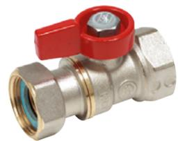
Valvola a sfera, con attacchi filettati femmina-femmina con calotta prigioniera e guarnizione di tenuta, specifica per impiego sotto caldaia e per collegamento contatori.
