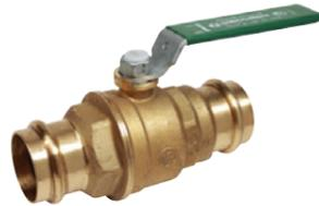
Valvola a sfera, con attacchi a pressare (per tubo in rame conforme alla EN 1057; per tubo in acciaio inossidabile conforme alla EN 10217-7 e EN 10312; per tubo in acciaio al carbonio conforme alla EN 10305-3), specifica per acqua sanitaria.
