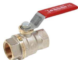
Valvola con sfera DADO, con attacchi filettati femmina-femmina, serie pesante. Passaggio totale. Temperatura minima di esercizio: -20 °C con soluzioni glicolate al 50 % Temperatura massima di esercizio con vapore saturo secco: 185 °C con 1,05 MPa (10,5 bar) Pressione massima di esercizio a 20 °C con acqua e gas non pericolosi: 4,2 MPa (42 bar) per 1/4", 3/8", 1/2", 3/4" 3,5 MPa (35 bar) per 1", 1-1/4", 1-1/2", 2"
