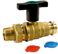
Valvola a sfera, con attacchi filettati maschio a bocchettone-a pressare (per tubo in rame conforme alla EN 1057; per tubo in acciaio inossidabile conforme alla EN 10217-7 e EN 10312; per tubo in acciaio al carbonio conforme alla EN 10305-3), per tubazioni con elevato spessore isolante, specifica per acqua sanitaria.
