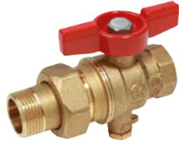
Valvola a sfera, con attacchi filettati femmina-maschio a bocchettone, con portasonda filettato femmina M10x1 mm, per sonda Ø 6 mm.
