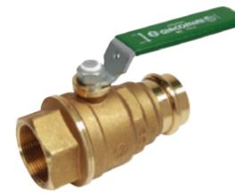
Valvola a sfera, con attacchi filettati femmina-a pressare (per tubo in rame conforme alla EN 1057; per tubo in acciaio inossidabile conforme alla EN 10217-7 e EN 10312; per tubo in acciaio al carbonio conforme alla EN 10305-3), specifica per acqua sanitaria.
