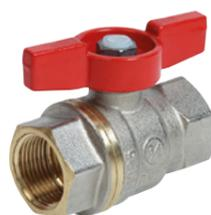
Valvola con sfera DADO, con attacchi filettati femmina-femmina, serie pesante. Passaggio totale. Temperatura minima di esercizio: -20 °C con soluzioni glicolate al 50 % Temperatura massima di esercizio con vapore saturo secco: 185 °C con 1,05 MPa (10,5 bar) Pressione massima di esercizio a 20 °C con acqua e gas non pericolosi: 4,2 MPa (42 bar) per 1/4", 3/8", 1/2", 3/4" 3,5 MPa (35 bar) per 1", 1-1/4"
