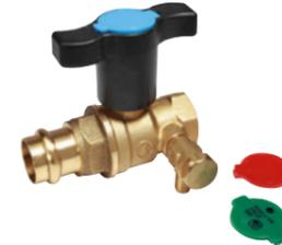
Valvola a sfera, con attacchi filettati femmina-a pressare (per tubo in rame conforme alla EN 1057; per tubo in acciaio inossidabile conforme alla EN 10217-7 e EN 10312; per tubo in acciaio al carbonio conforme alla EN 10305-3), con rubinetto di scarico con portagomma Ø 9 mm, specifica per acqua sanitaria.
