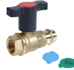
Valvola a sfera, con attacchi filettati femmina-a pressare (per tubo in rame conforme alla EN 1057; per tubo in acciaio inossidabile conforme alla EN 10217-7 e EN 10312; per tubo in acciaio al carbonio conforme alla EN 10305-3), per tubazioni con elevato spessore isolante, specifica per acqua sanitaria.
