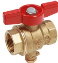
Valvola a sfera, con attacchi filettati femmina-femmina, con portasonda filettato femmina M10x1 mm, per sonda Ø 6 mm.
