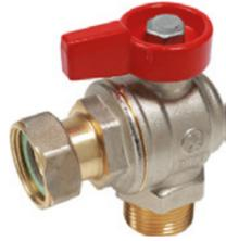
Valvola a sfera a squadra, con attacchi filettati maschio-femmina con calotta prigioniera e guarnizione di tenuta, specifica per impiego sotto caldaia e per collegamento contatori.
