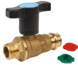
Valvola a sfera, con attacchi filettati maschio-a pressare (per tubo in rame conforme alla EN 1057; per tubo in acciaio inossidabile conforme alla EN 10217-7 e EN 10312; per tubo in acciaio al carbonio conforme alla EN 10305-3), per tubazioni con elevato spessore isolante, specifica per acqua sanitaria.
