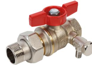
Valvola con sfera DADO, con attacchi filettati femmina-maschio a bocchettone, con rubinetto di scarico con portagomma Ø 9 mm.
