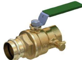
Valvola a sfera, con attacchi filettati femmina-a pressare (per tubo in rame conforme alla EN 1057; per tubo in acciaio inossidabile conforme alla EN 10217-7 e EN 10312; per tubo in acciaio al carbonio conforme alla EN 10305-3), con rubinetto di scarico con portagomma Ø 9 mm, specifica per acqua sanitaria.
