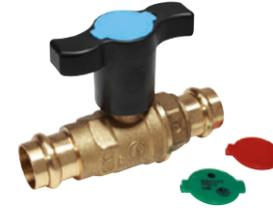
Valvola a sfera, con attacchi a pressare (per tubo in rame conforme alla EN 1057; per tubo in acciaio inossidabile conforme alla EN 10217-7 e EN 10312; per tubo in acciaio al carbonio conforme alla EN 10305-3), per tubazioni con elevato spessore isolante, specifica per acqua sanitaria.
