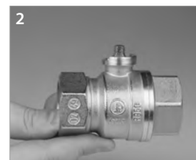
2 Togliere la leva ed inserire il nuovo anello premistoppa in PTFE (contenuto nella confezione), senza rimuovere quello già presente
