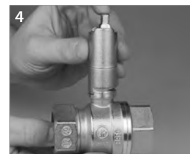
4 Avvitare il perno centrale della prolunga sull'asta della valvola a sfera e serrare a fondo utilizzando la leva della valvola a sfera
