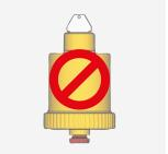
**A AVVERTENZA.** Chiudere il tappo della valvola di sfogo aria durante le operazioni di lavaggio e di riempimento dell'impianto, per evitare che le impurità entrino nei meccanismi della valvola, danneggiandola.
