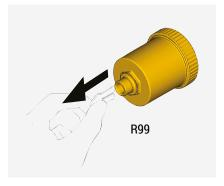
Dopo aver avvitato il rubinetto R160 sulla sede di installazione, rimuovere l'eventuale paletta in plastica già presente sulla valvola automatica di sfogo aria e procedere con il montaggio.
