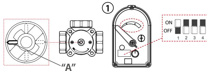
**i** Quando si cambia la posizione del DIP1, si ha la calibrazione dell'attuatore. Il LED lampeggia (1x/sec) e l'attuatore viene ruotato verso il lato destro e sinistro. In questi casi lasciare l'attuatore in posizione AUTO, non cambiare settaggi e non togliere l'alimentazione elettrica. Durante la calibrazione dell'attuatore, per protezione dell'impianto, è necessario spegnere il circolatore per prevenire oscillazioni di temperatura nell'impianto.
