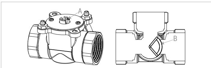
Il rotore della valvola ha un angolo di rotazione di 90° in entrambi i sensi (orario e antiorario); quindi a seconda del punto di partenza impostato esso può muoversi all'interno di un range di ±90°.
