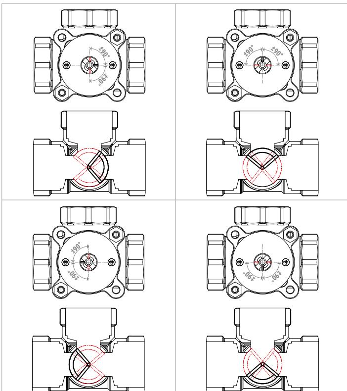
In base alla rotazione che si vuole far compiere al rotore è necessario impostare correttamente i valori di funzionamento dell'attuatore tramite i DIP Switch interni allo stesso (direzione di rotazione, segnale di controllo, ecc..)
