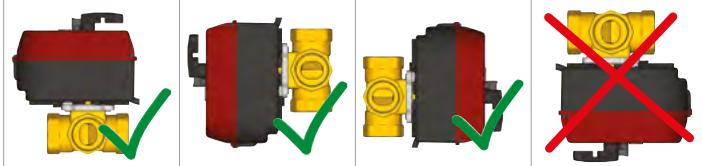
Prima di installare l'attuatore sulla valvola è necessario posizionare manualmente lo stelo della stessa in base al funzionamento che si desidera (funzionamento come valvola miscelatrice o come valvola deviatrice). L'intaglio (A) presente sullo stelo della valvola indica sempre l'attuale posizione del rotore (B).
