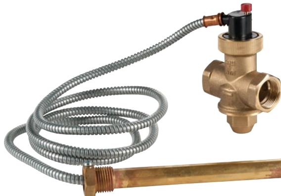
La valvola di scarico di sicurezza termica R144ST è un dispositivo limitatore della temperatura dell'acqua nei generatori policombustibili o a combustibile solido non polverizzato provvisti di bollitore incorporato o di scambiatore di emergenza (per il raffreddamento immediato).
