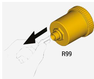
Dopo aver avvitato il rubinetto R160 sulla sede di installazione, rimuovere l'eventuale paletta in plastica già presente sulla valvola automatica di sfogo aria e procedere con il montaggio.
