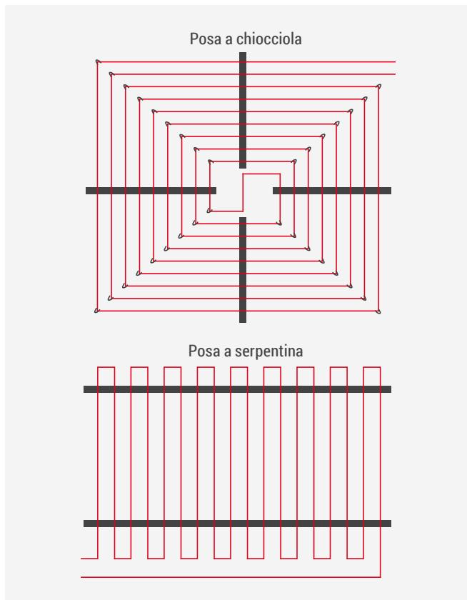
È possibile posare la tubazione in modi differenti creando anelli a chioccia oppure a serpentina a seconda delle necessità.
