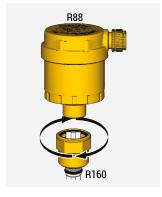
Avvitare la valvola automatica di sfogo aria al rubinetto R160, facendo in modo che la paletta in plastica sia guidata dal foro del corpo della valvola di sfogo aria.
