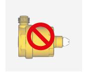
▲ AVVERTENZA. Chiudere il tappo della valvola di sfogo aria durante le operazioni di lavaggio e di riempimento dell'impianto, per evitare che le impurità entrino nei meccanismi della valvola, danneggiandola.
