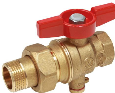
Valvola a sfera, attacchi filettati femmina-maschio a bocchettone, con portasonda filettato femmina M10x1 mm, per sonda Ø 6 mm.
