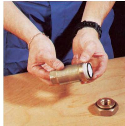
3) controllare che i due moduli di ritegno funzionino perfettamente; non devono esserci impurezze sulla sede di tenuta o sulla molla di chiusura. Nel caso in cui i moduli siano guasti, sostituirli.
