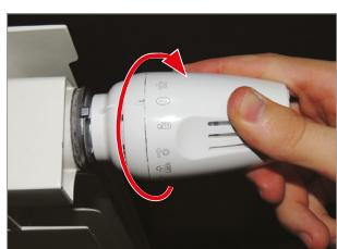
**3)** Chiudere completamente la testa termostatica girando la manopola (posizione "0"), l'anello Clip Clap si aggancerà automaticamente alla valvola.
