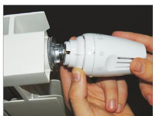
**1)** Aprire completamente la testa portando la manopola in posizione . Successivamente tirare l'attacco Clip Clap verso la manopola.
