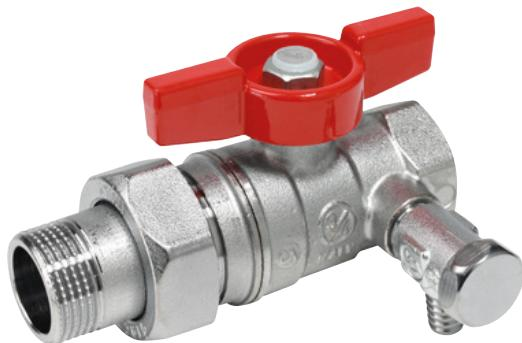
Valvola a sfera, attacchi femmina-maschio a bocchettone, con rubinetto di scarico con portagomma Ø 9 mm. Passaggio standard.
