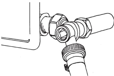
**AVVERTENZA.** Utilizzare una chiave esagonale da 10 mm con estremità smussate, per non danneggiare la guarnizione di tenuta in gomma.
