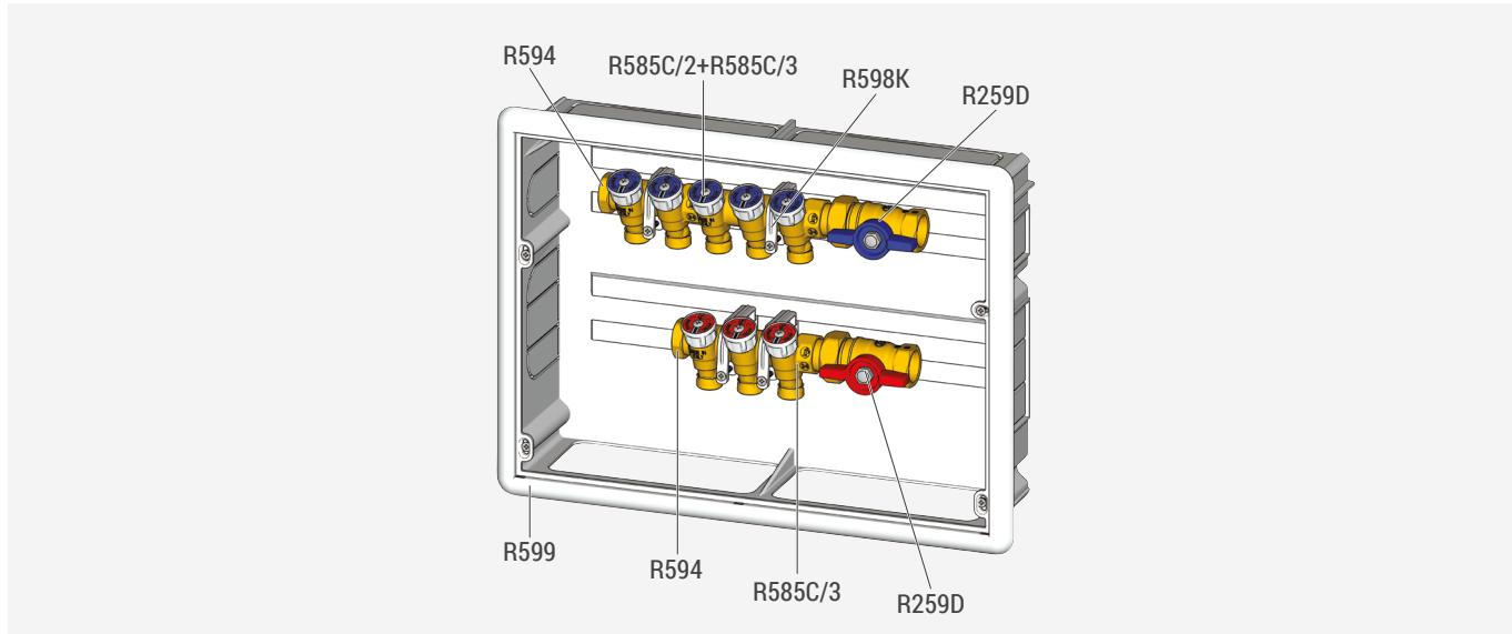
Il montaggio dei collettori all'interno della cassetta R599, mediante gli appositi supporti scorrevoli R598K, avviene su guide orizzontali e quindi senza vincoli di posizionamento. Sfruttando le ampie aperture ricavate sul fondo della cassetta, inoltre, si possono comodamente installare collettori con interassi differenti.
