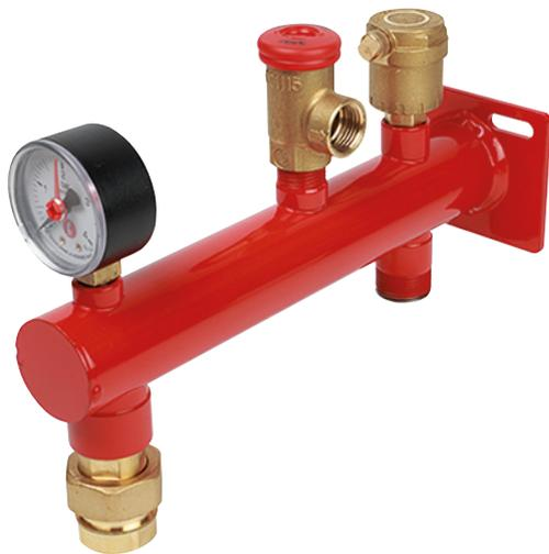
Collettore portastrumenti con corpo in acciaio, per il raggruppamento di diversi componenti per centrale termica. Predisposto per fissaggio a parete. Completo di valvola di sicurezza (3 bar), manometro (0÷4 bar), valvola di sfogo aria automatica e intercettazione automatica (doppia valvola di non ritorno) con attacco G 3/4" F per vaso d'espansione.
