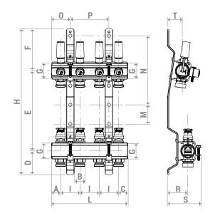
R500Y221 (400x650x85±130 mm) R500Y222 (600x650x85±130 mm) R500Y223 (800x650x85±130 mm) R500Y224 (1000x650x85±130 mm)
