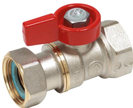
Valvola a sfera, attacchi filettati femmina-femmina con calotta prigioniera e guarnizione di tenuta, specifica per impiego sotto caldaia e per collegamento contatori. Passaggio standard.
