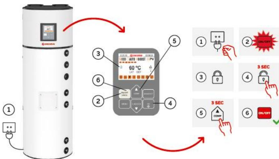
**Note 1:** Le voyant du bouton 'ON/OFF' indique l'état de l'appareil. Lorsque la LED clignote, le compresseur n'est pas encore activé et le bouton 'COMP' doit être enfoncé pendant 3 secondes. Ensuite, la LED du bouton 'ON/OFF' s'allumera en permanence et l'appareil fonctionnera normalement.
