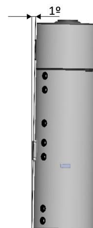
L'appareil doit être mis à niveau à l'aide des pieds réglables situés au bas de l'appareil.
