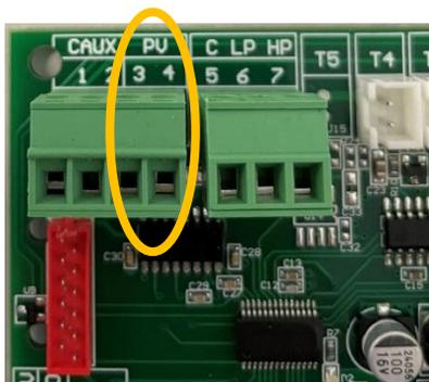
Lorsque le contact se ferme, le mode PV est activé et les paramètres de toutes les sources de chaleur actives (pompe à chaleur + résistance électrique) sont ajustés : le compresseur de la pompe à chaleur adopte les paramètres P01-PV / H01-PV (au lieu de P01 et H01) et la résistance électrique les paramètres P02-PV / H02-PV (au lieu de P02 et H02).
