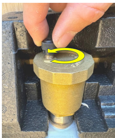
Ouverture du capuchon de la soupape de purge
